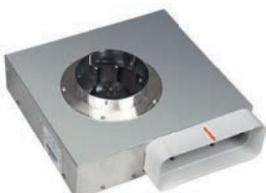
Bewährte AC- und EC- Sockellüfter in neuer Ausführung mit abnehmbaren Stutzen. Dadurch einfachere Montage und Austausch des Motors - kann einfach unter dem Schrank durchgeschoben werden. Abmessungen identisch mit den bisherigen - siehe Product Book.
