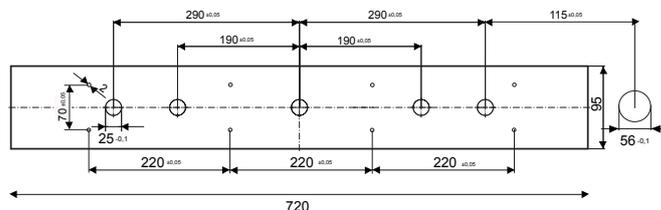
Schaltkasten – Abmessungen & Bohrungen
